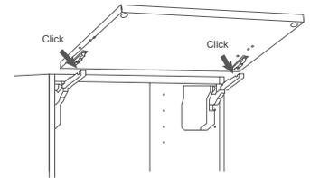
2. Befestigung des Küchen Smart am Federscharnier. Das Gerät darf bei diesem Installationsvorgang noch nicht mit der Stromversorgung verbunden sein.
