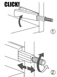
4. Verbinden Sie jetzt den Drucktüröffner mit den Befestigungsclips und justieren Sie ihn ggf. nach.
