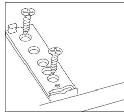
3. Montieren Sie nun den Befestigungsclip für den Drucktüröffner. Wir empfehlen die Montage beider Befestigungsclips übereinander.
